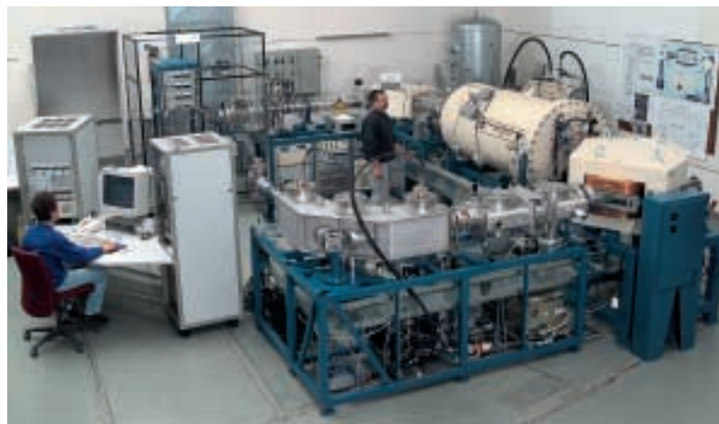
Abb. 2: Osteoporose-Forschung mit Hilfe der Teilchenphysik: Calcium-41-Nachweis im Urin mittels Beschleunigungs-Massenspektrometrie.
